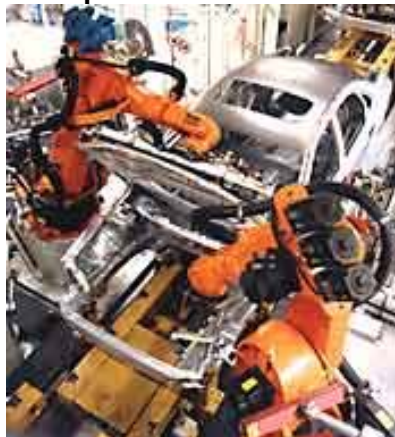
Chaîne d'assemblage robotisée d'automobiles
